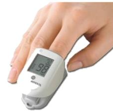
これを指先に装着し、経皮的 (皮膚を通して) 光をあて動脈の色を計測することで動脈酸素飽和度 (SpO<sub>2</sub>) を測定します。呼吸状態、体内の酸素状態を知る目安となります
